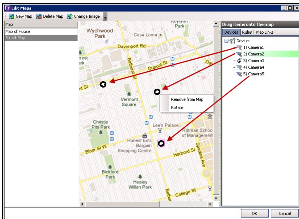
图 23. 将摄像头拖动到地图上
