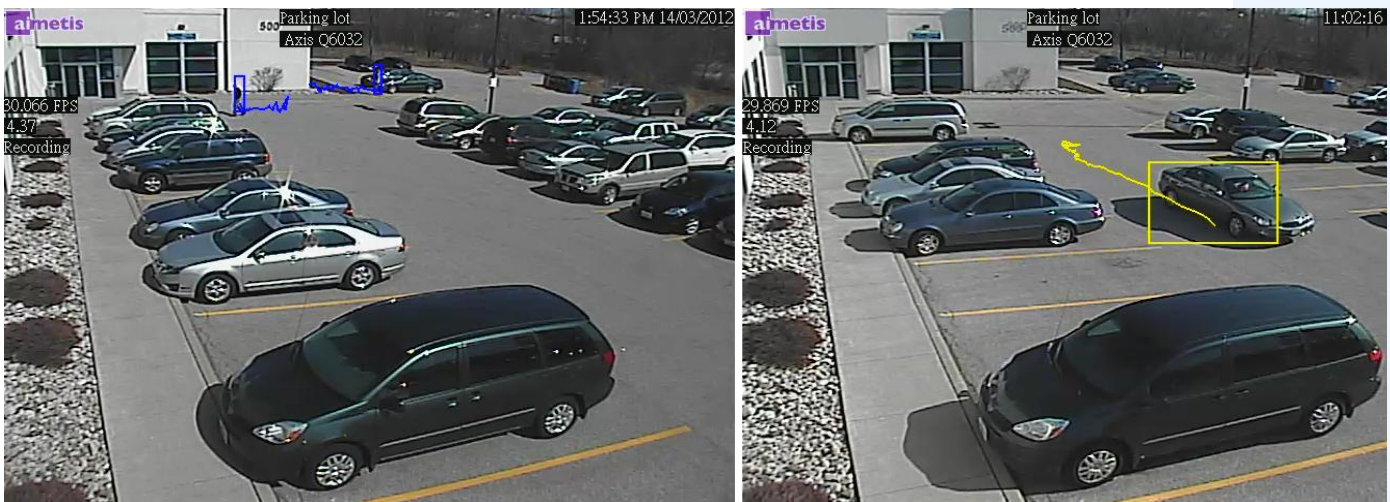
Imagen 5. Mismo aparcamiento: línea de rastreo azul para las personas y línea de rastreo amarilla para el vehículo
