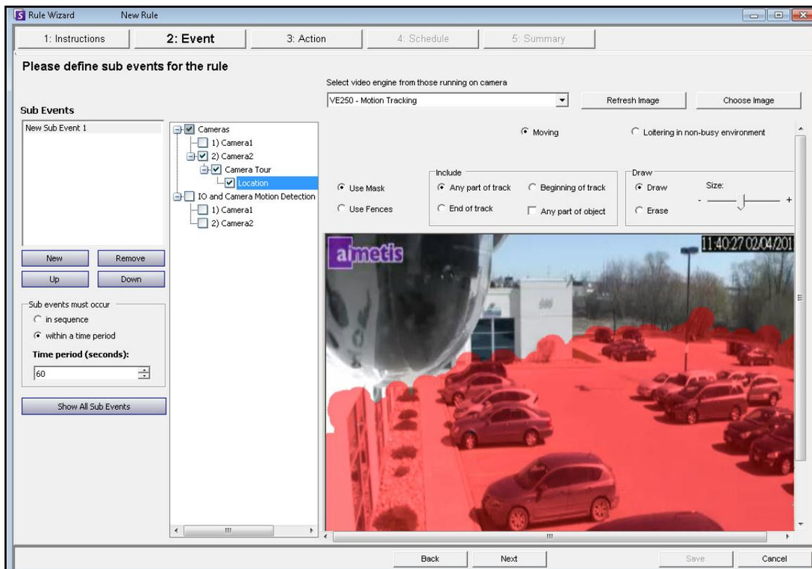
Abbildung 31. Reglassistent – Beispiel für die Definition einer Alarmzone
