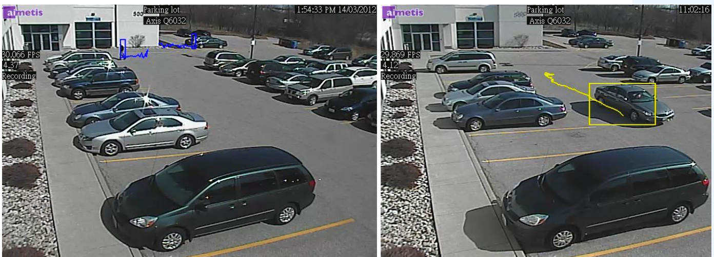
Figure 14. Sur le même parking : ligne de suivi bleue pour une personne, jaune pour un véhicule
