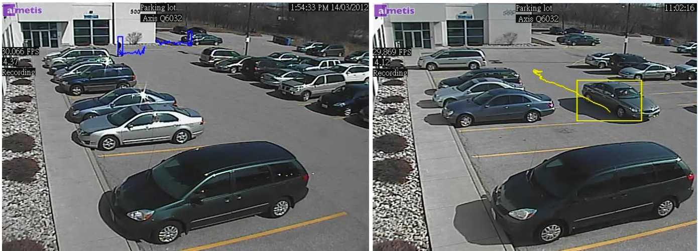
Imagen 14. Mismo aparcamiento: línea de rastreo azul para las personas y línea de rastreo amarilla para el vehículo
