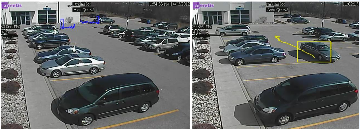
图 5. 同一停车场：蓝色跟踪线表示人，黄色跟踪线表示车辆
