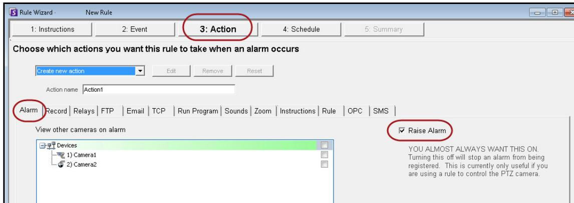
Figure 32. Option **Émettre une alarme** sélectionnée
