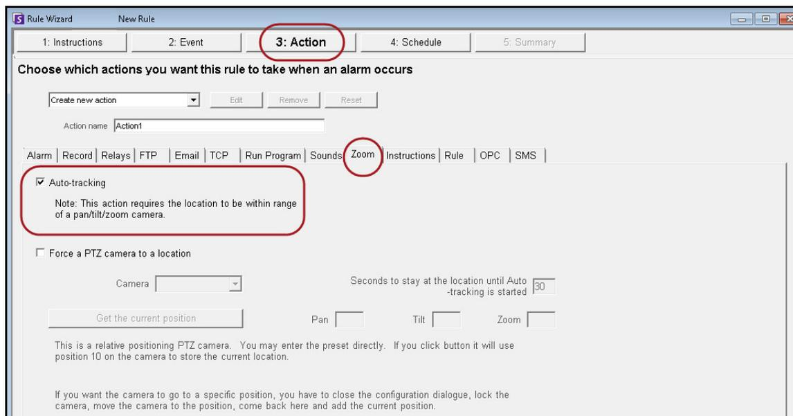
Figure 33. Onglet **Zoom** avec l'option **Suivi automatique** sélectionnée
