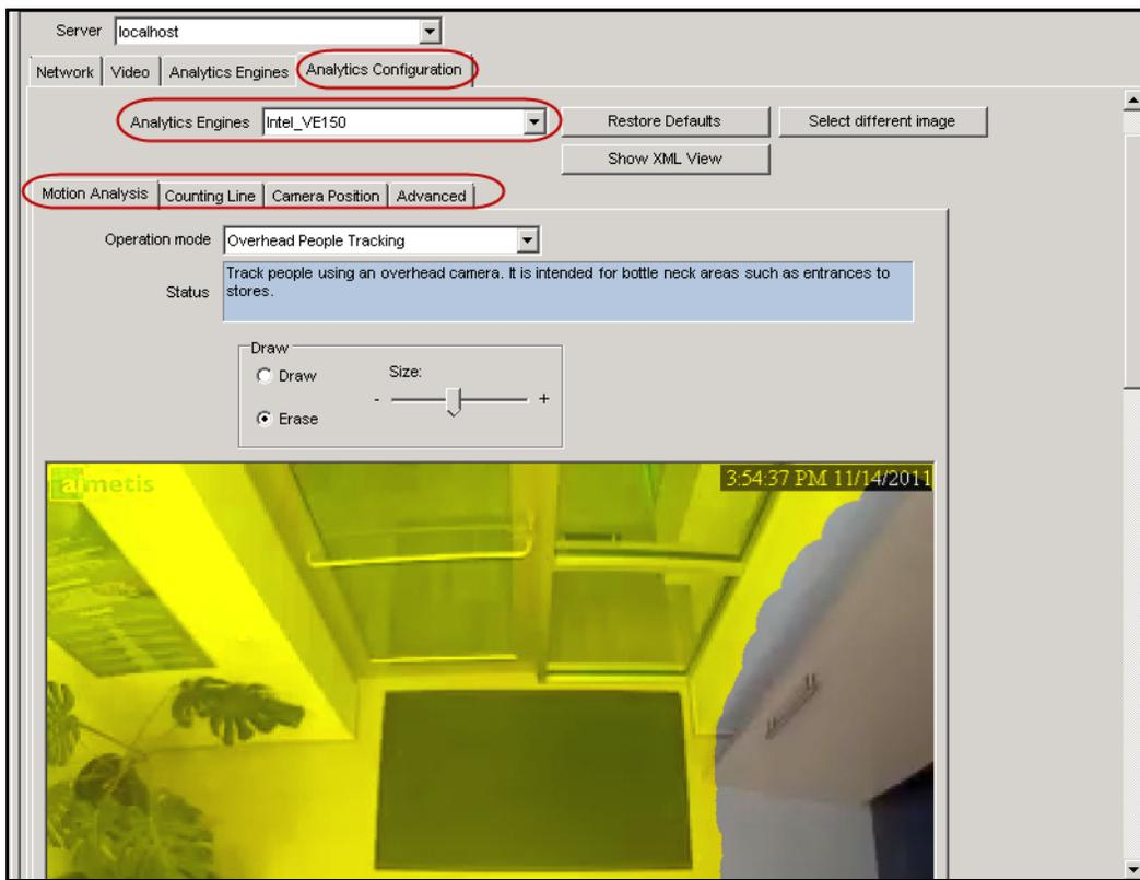
Figure 9. Onglet Configuration de l'analyse pour le moteur VE150
