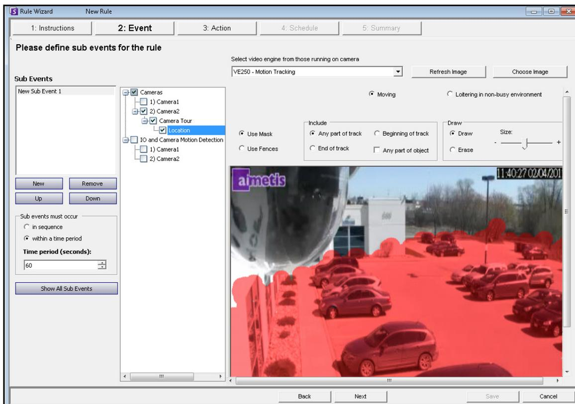
Figure 31. Assistant de règles - Exemple de définition d'une zone d'alarme
