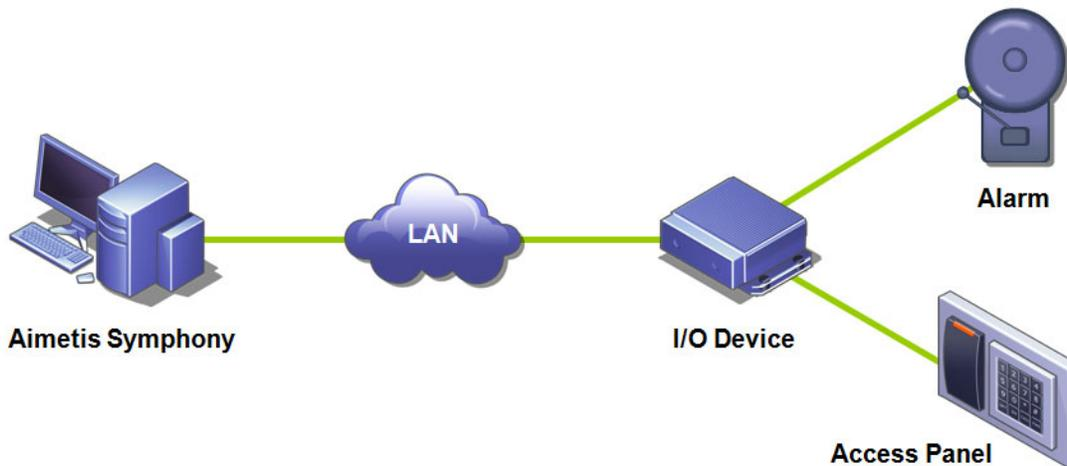
Imagen 8. El PC envía una señal mediante LAN. El dispositivo de E/S de la red LAN recibe la señal y la transmite a una alarma en una entrada o un panel de alarma en otra entrada.
