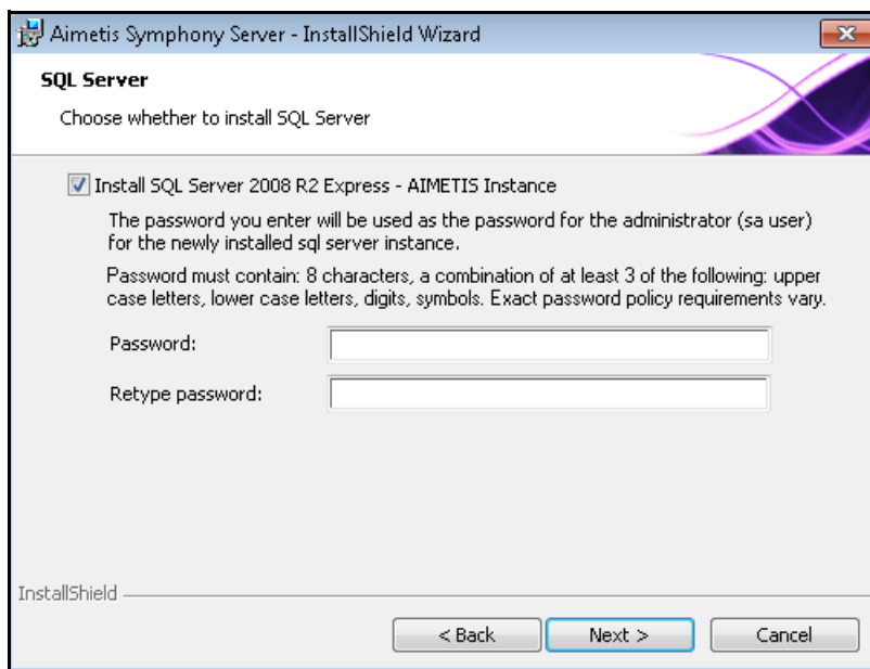
Figure 4. Écran SQL Server avec la case Install SQL Server Express 2008 R2 (Installer SQL Server Express 2008 R2) cochée
