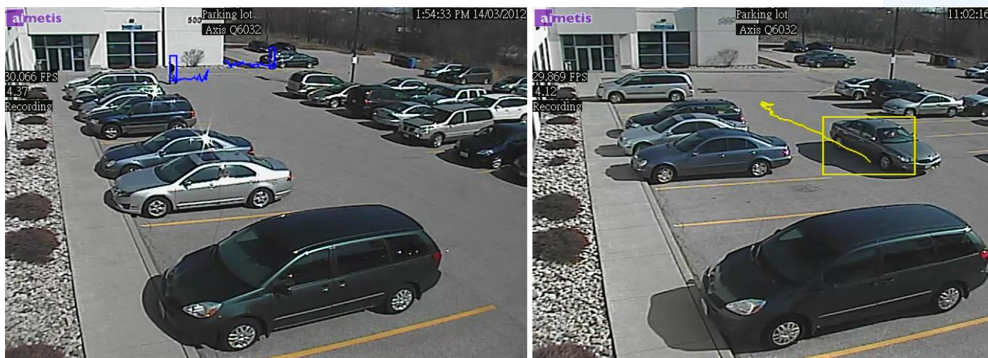
图 14. 同一停车场：蓝色跟踪线表示人，黄色跟踪线表示车辆
