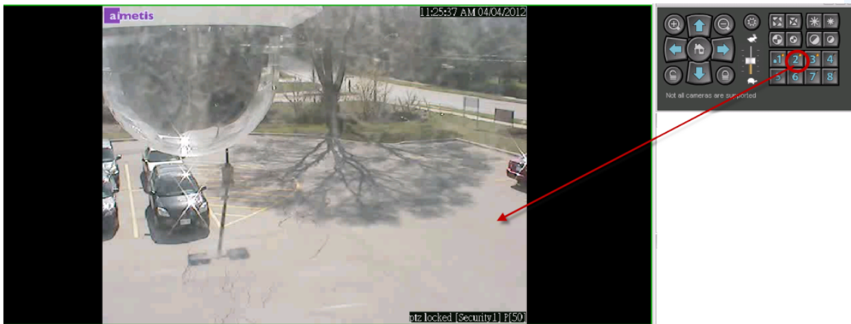
图 41. 在 PTZ 控件中单击 2，可以将摄像头移动到摄像头巡视中的位置 2
