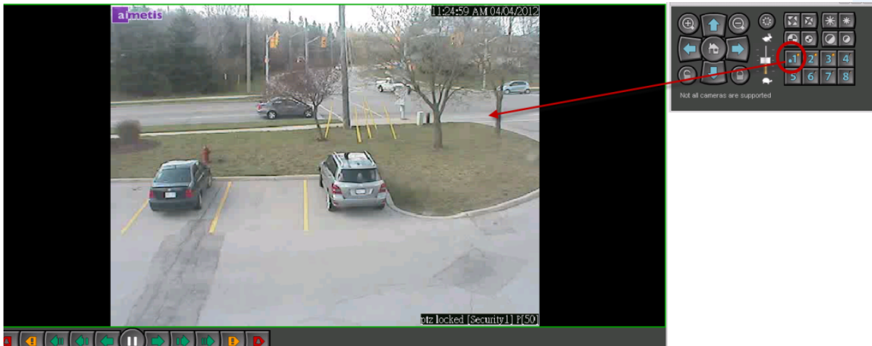
Imagen 40. Los números de los controles PTZ representan las posiciones del recorrido de la cámara
