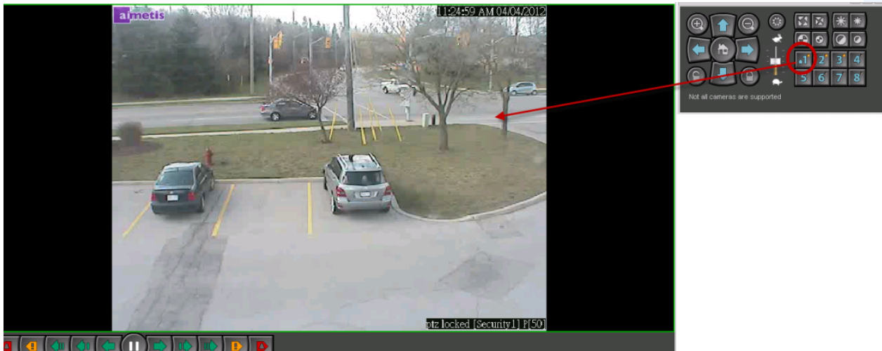
Figura 40. Os números nos controles PTZ representam as posições da ronda da câmera
